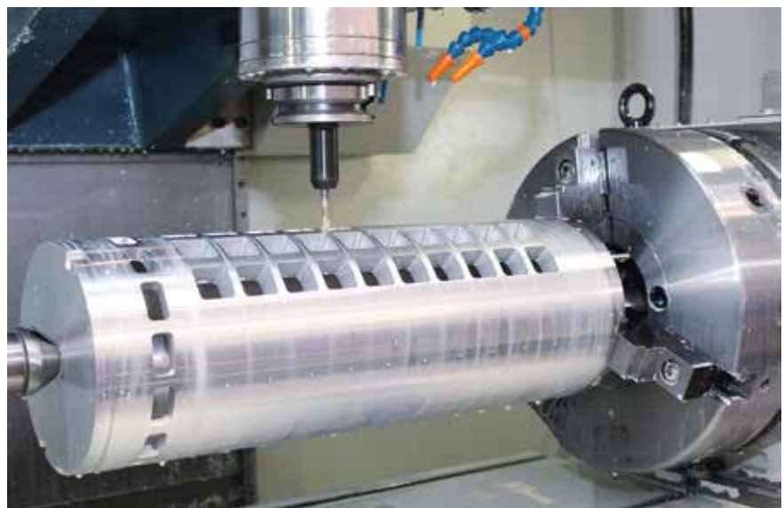
Walzwerkzeug: Je nach Größe, Komplexität und Materialbeschaffenheit laufen die Romi-Bearbeitungszentren bei K&S nur wenige Minuten oder viele Stunden mannos über Nacht. (Bild: Siemens)
