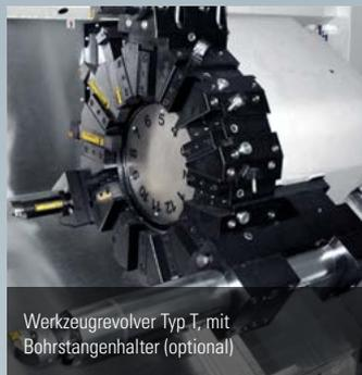
Werkzeugrevolver Typ T, mit Bohrstangenhalter (optional)
