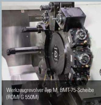
Werkzeugrevolver Typ M, BMT-75-Scheibe (ROMI G 550M)
