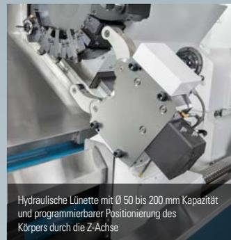
Hydraulische Lünette mit Ø 50 bis 200 mm Kapazität und programmierbarer Positionierung des Körpers durch die Z-Achse
