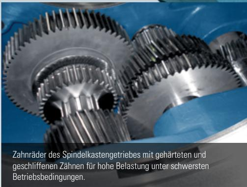
Zahnräder des Spindelkastengetriebes mit gehärteten und geschliffenen Zähnen für hohe Belastung unter schwersten Betriebsbedingungen.
