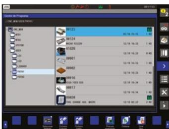
4. Die Bearbeitungsprogramme sind einfach aufzurufen, sie sind in Ordnerstruktur mit Abbildung des Werkstücks, Programmname und -nummer zur leichteren Identifizierung organisiert.
