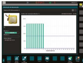
3. Informationen zur präventiven und korrekiven Instandhaltung (Meldungen, Alarme, Meldungshistorie usw.). Fehlermeldungen werden bereits ausgegeben, bevor es zu einer Störung kommt. Dies ermöglicht eine effektive Instandhaltung.
