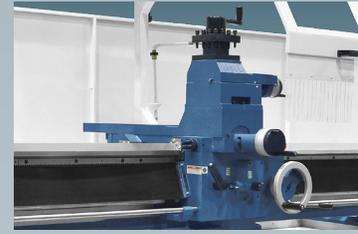
**Die Leit- und Zugspindel ist aus rostfreiem Stahl hergestellt.**
