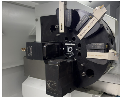
8-Stationen- Scheibenrevolver VDI 30 für angetriebene Werkzeuge, hinter Drehmitte (Option) ▶
