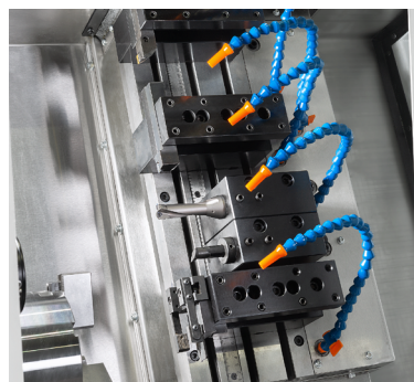
"Gang Tools"-System für Werkzeughalter: 60°-Neigung, einfacher Zugang des Bedieners zu den Werkzeughaltern und Spanabfuhr
